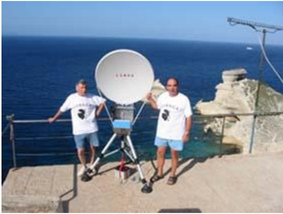
Foto expedición de TK/F1AAM y TK/F5BUU portables en Córcega. Señal en 10.400 MHz 400 Kms. Recibida en Barcelona 2004
